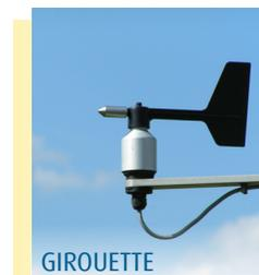
La vitesse du vent sera mesurée par **quatre anémomètres** situés à différentes hauteurs et la direction du vent sera obtenue grâce à **deux girouettes**.
